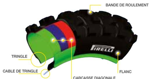
On les appelle également pneus conventionnels ou x-ply. Selon les spécificités de vitesse et de charge, la carcasse du pneu est composée de deux ou plusieurs couches superposées. Chaque couche se compose de fils de tissu revêtus de caoutchouc et l'angle de superposition est conçu pour donner au pneu les caractéristiques dynamiques requises.
